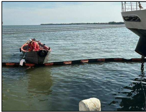
รูปที่ 2-1 เรือเล็กขนาดเครื่องยนต์ 24 แรงม้าใช้ในการลากบูม (Boom)
