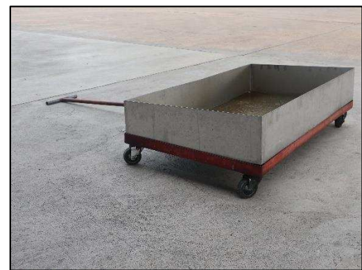
รูปที่ 2-4 การจัดเตรียมภาคเหล็กป้องกันการรั่วไหลไว้ในพื้นที่โครงการ
